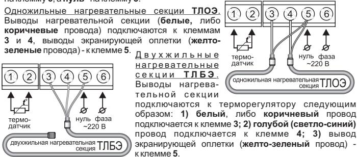
Двухжильные нагревательные секции ТЛБЭ. Выводы нагревательной секции подключаются к терморегулятору следующим образом: 1) белый, либо коричневый провод подключается к клемме 3; 2) голубой (светло-синий) провод подключается к клемме 4; 3) вывод экранирующей оплетки (желто-зеленый провод) - к клемме 5.
